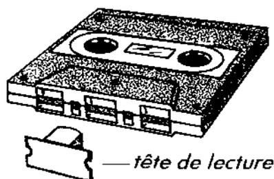
Le L.E.P. est un appareil robuste. Le seul élément réclamant un peu de soin et d'entretien est la tête de lecture. Nettoyez-la régulièrement avec un tampon d'alcool.
